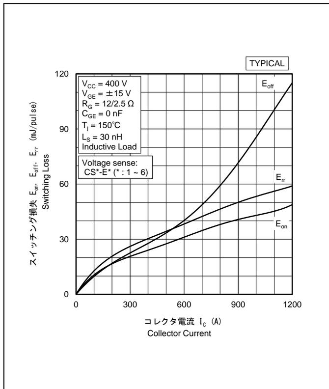
スイッチング損失-コレクタ電流特性
