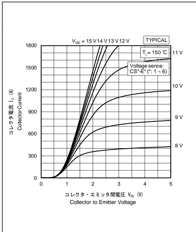
コレクタ電流—コレクタ・エミッタ間電圧特性 (150 °C)
