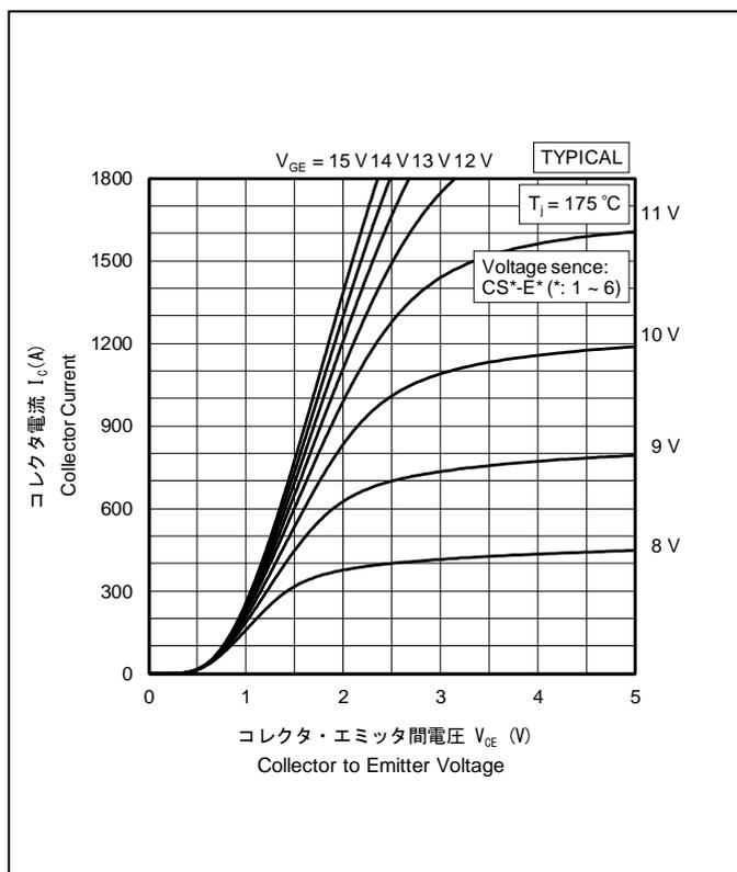
コレクタ電流—コレクタ・エミッタ間電圧特性 (175 °C)
