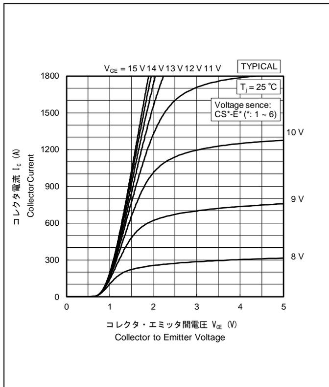
コレクタ電流—コレクタ・エミッタ間電圧特性 (25 °C)
